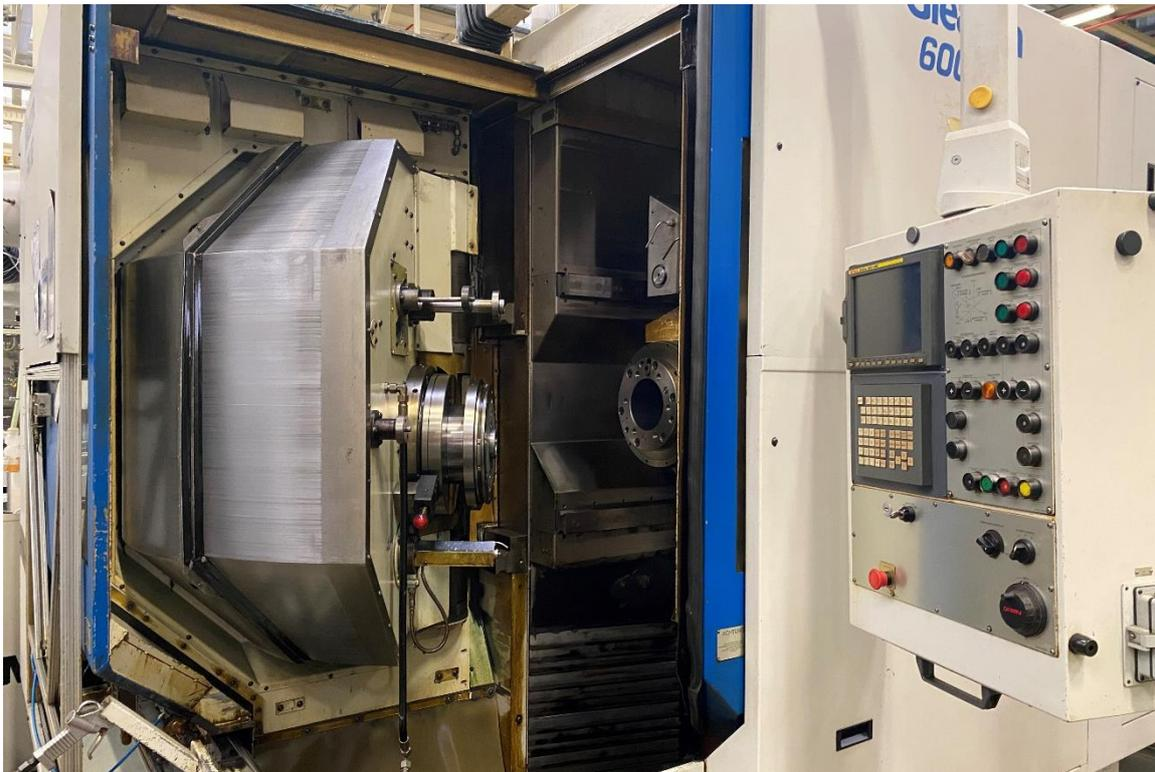
Mit der GLEASON Phoenix® 600HG Kegelradschleifmaschine können Hersteller von spiral- und hypoidverzahnten Kegelrädern mittlerer Größe schnellere Schleifzyklen und höhere Genauigkeiten bei gleichzeitig niedrigeren Schleifkosten erzielen.
